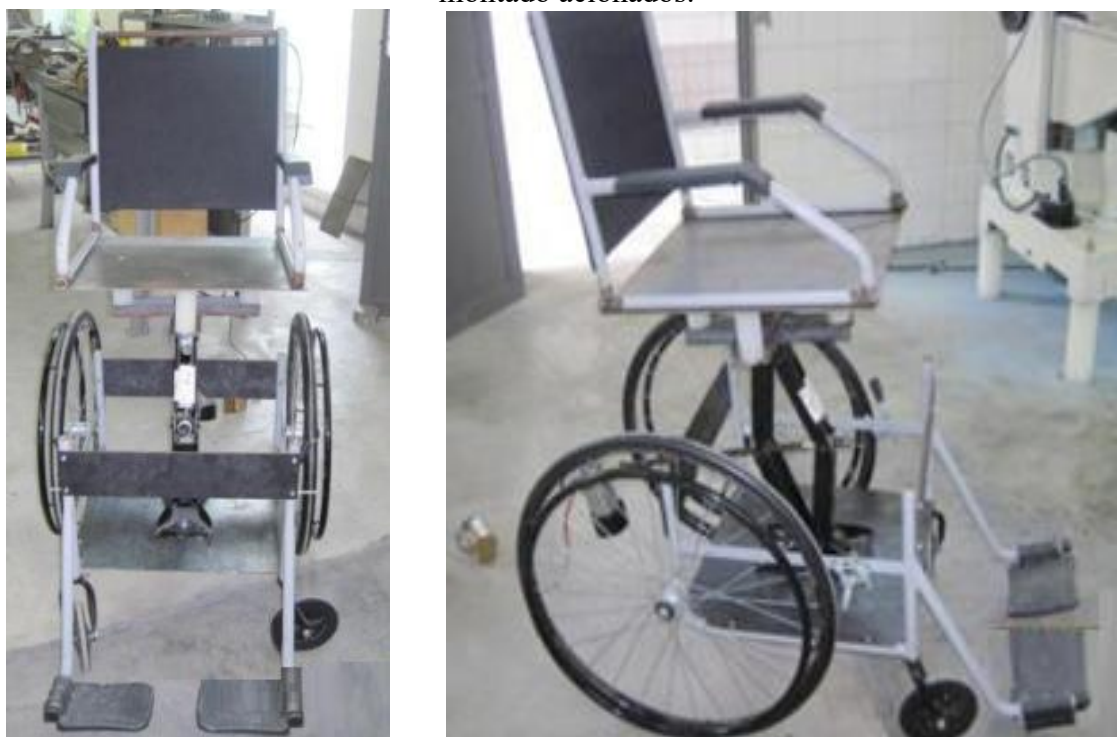
Figura 11 – Foto das imagens frontal e lateria do sistema de elevação e abaixamento montado acionados.
