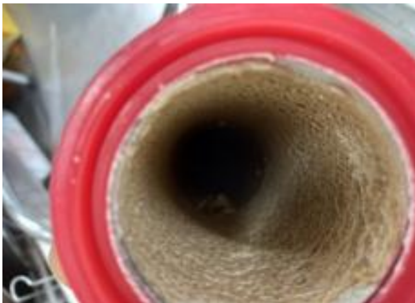
Figura 2- Aderência da solução de extrato de girassol e farinha de banana.
