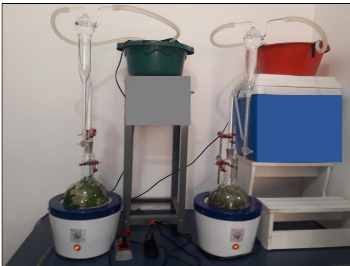
Figura 1. Extração de OEs por hidrodestilação utilizando o equipamento Clevenger.
