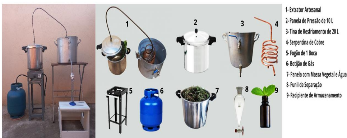
Figura 2. Extração de OEs por hidrodestilação utilizando o equipamento artesanal.
