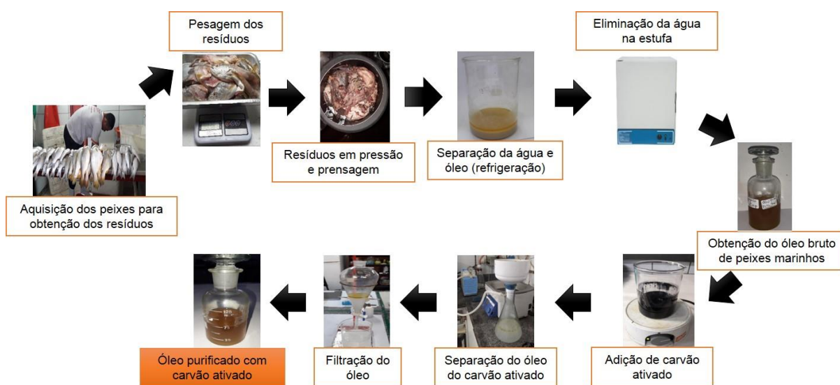
Figura 1: Fluxograma das etapas de extração e purificação com carvão ativado do óleo de peixes marinhos.
